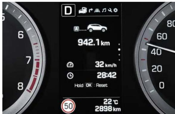
**Verkehrszeichen-Assistent<sup>1</sup>.** Das System erkennt Verkehrsschilder, gleicht die Informationen mit Navigationsdaten ab und zeigt die jeweilige Geschwindigkeitsbegrenzung bzw. Überholverbote auf dem Navigationsbildschirm und dem hochauflösenden TFT-Display an.
