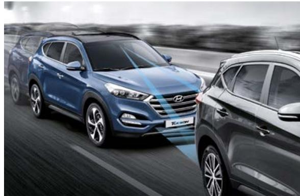
**Autonomer Notbremsassistent<sup>1</sup>.** Der durch Radar und Kamera gesteuerte Autonome Notbremsassistent warnt den Fahrer vor potenziellen Gefährdungen durch andere Fahrzeuge und Fußgänger. Er bremst das Fahrzeug im Notfall automatisch ab.
