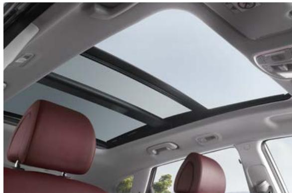
**Panorama-Glas-Schiebedach<sup>1</sup>.** Das große Panorama-Schiebedach verheißt ein Fahrerlebnis unter freiem Himmel. Per Knopfdruck wird der Innenraum mit Frischluft und Sonnenlicht durchflutet. Ein automatischer ausklappender Windabweiser minimiert den Geräuschpegel.
