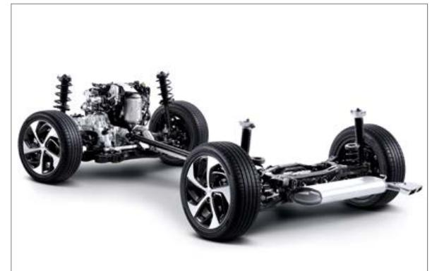
**Zuschaltbarer Allradantrieb.** Bei potenziellem Traktionsverlust werden bis zu 50 % des Drehmoments auf die Hinterräder übertragen, um die Haftung auf losem, rutschigem Untergrund und das Kurvenverhalten zu verbessern. Bei extremen Bedingungen kann die Drehmomentverteilung im 50 : 50-Modus arretiert werden.
