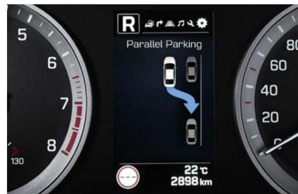
**Autom. Einparkassistent<sup>1</sup>.** Die aktivierten Sensoren können einen passenden Parkplatz erkennen und den Tucson perfekt hinein- und hinaussteuern. Auch um rechtwinklige Hindernisse wird der Wagen automatisch geführt. Sie betätigen Gaspedal und Bremse, das System erledigt den Rest.
