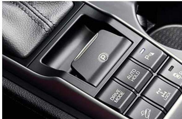
**Elektrische Parkbremse<sup>1</sup>.** Durch die kompakte Parkbremsen-Steuerung mit praktischer Auto-Release-Funktion wird nutzbarer Platz zwischen den Vordersitzen frei.
