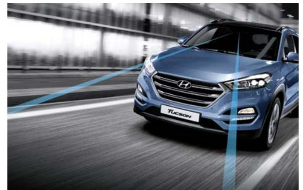
**Spurhalte-Assistent<sup>1</sup>.** Bei unbeabsichtigtem Verlassen der Fahrspur erfolgen sogleich eine optische und akustische Warnung sowie eine automatische Lenkkorrektur.
