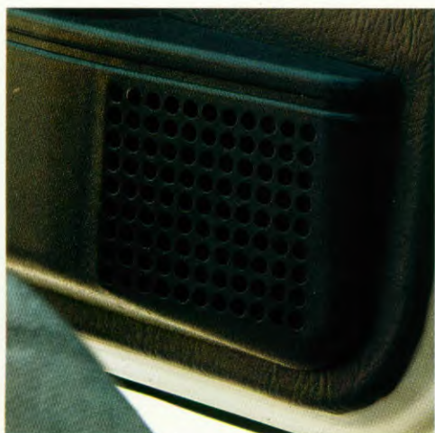
Luidsprekers zijn ingebouwd, twee in de L, vier in de GSL.
