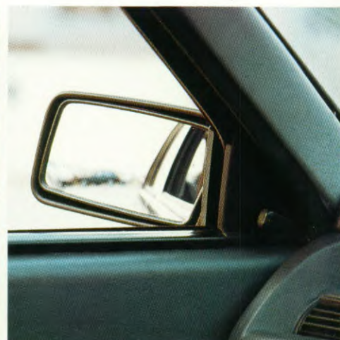
Van binnenuit verstelbare buitenspiegel (GSL).
