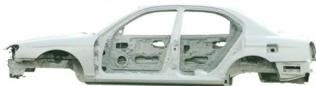
'Body Guard': een stalen veiligheidsceel beschermt de inzittenden. Kreukelzones voor en achter en verstevigingen van speciaal staal in de stijlen, vloer en andere belangrijke delen helpen de botsing te absorberen.
