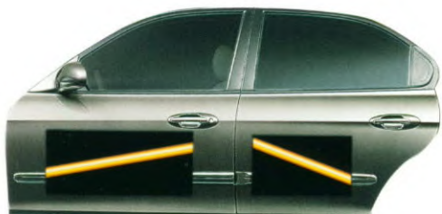
Side Impact Protection: stalen balken in de portieren vangen een botsing op. Deurstijlen, dorpel en dwarsbalken in de vloer zijn verstevigd voor extra zekerheid.
