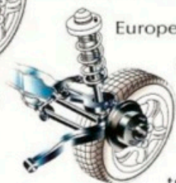
La suspensión frontal y trasera de tipo McPherson, ofrecen un excelente manejo.
