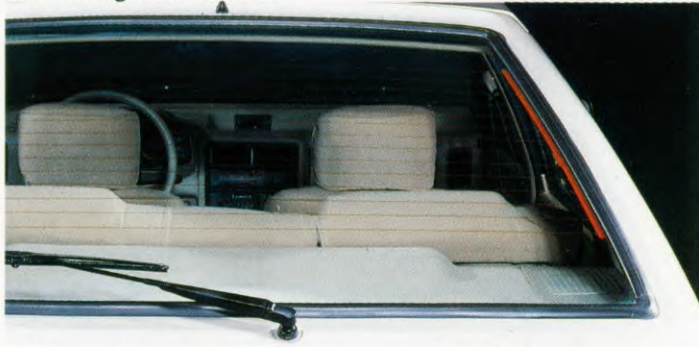
Achterrautverwarming en wis-/wasinstallatie
