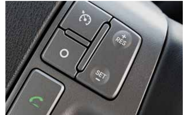
Geschwindigkeitsregelanlage. Serienmäßig bei der 5-Stufen-Automatik. Die Geschwindigkeitsregelanlage hält Abstand zum vorausfahrenden Fahrzeug und passt die Geschwindigkeit automatisch an.
