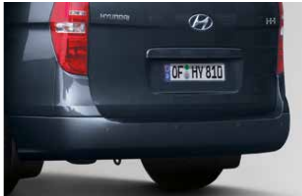
Einparkhilfe hinten 1 . Rückwärts einparken ist mit dem Hyundai H-1 Travel ein Leichtes. Sensoren im Heckbereich erfassen Hindernisse und warnen mit einem akustischen Signal.
