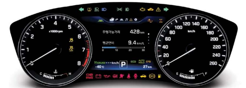
7인치 대형 모니터를 적용한 TFT LCD 클러스터
