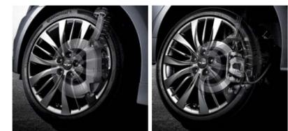
HTRAC(에이치트랙)은 다른 차에서 이미 선보여온 기계식 4륜 구동 방식과는 달리 차량 속도 및 노면 상태를 감지하여 좌우 바퀴의 제동력과 전륜, 후륜의 동력을 가변 제어하여 미끄러운 도로와 코너링 운전에서도 안정적으로 주행이 가능하도록 진화한 4륜 구동 시스템입니다. 또한 다양한 구동력 배분 제어가 제한적인 일반 전자식 승용 AWD와 다르게 운전자 선택에 따라 후륜 구동에서 4륜 구동의 변화특성을 차별화한 2가지 모드로 구동력 배분 제어가 가능합니다.
