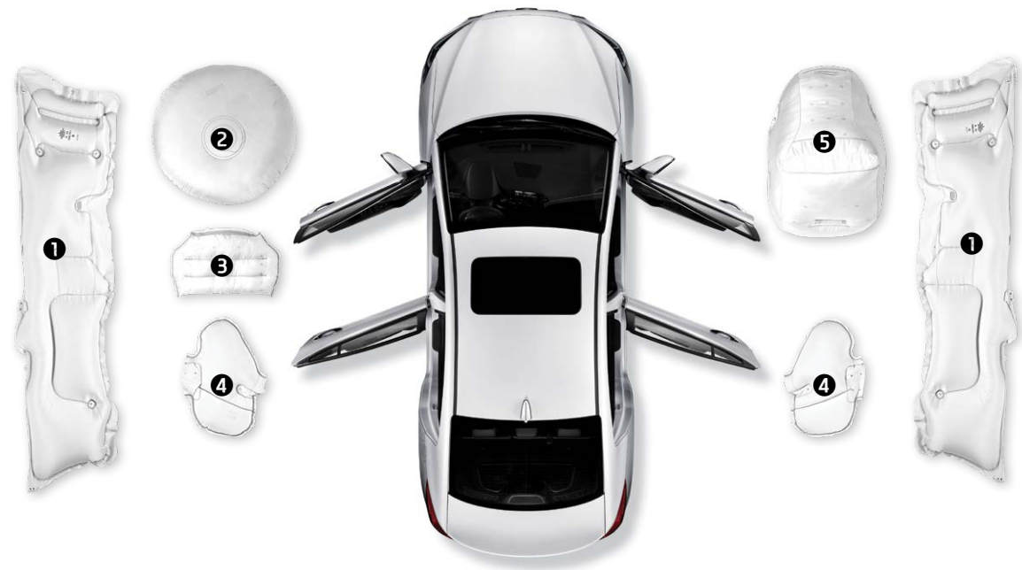
❶ 전복 감지 대응 커튼 에어백 ❷ 운전석 에어백 ❸ 운전석 무릎 에어백 ❹ 앞좌석 사이드 에어백 ❺ 동승석 에어백
