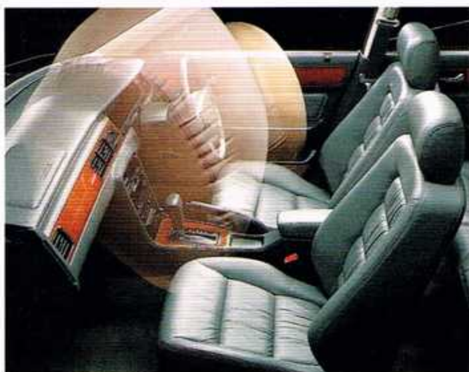
運転席用&助手席用SRSエアバッグシステム(作動時の写真合成・カットボディによる撮影)
