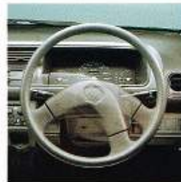
⑤パワーステアリング フル油圧式で、ひときわ軽く扱え、車庫入れ・総列駐車もらくにできます。
