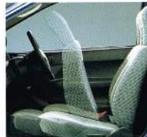
④助手席ウォークイン機構(SF7) 背もたれを前に倒すと、シートが前に動かせ、後席への乗り降りがらくにできます。
