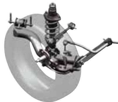
Schafft Platz für den flachen Boden: die kompakte Double-Wishbone-Radaufhängung mit Spurkontrollarm hinten.
