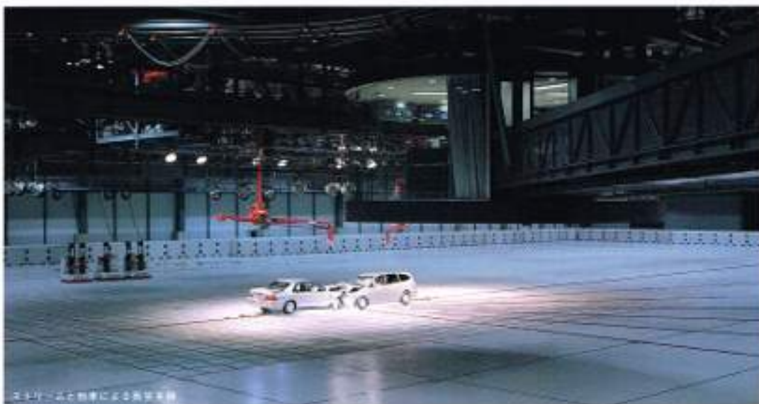
ストリームと物車による衝突実験
