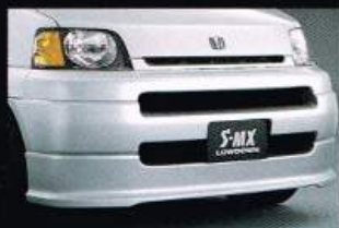
ボディ同色フロント大型バンパー & ボディ同色ウオッシャー・ノズル
