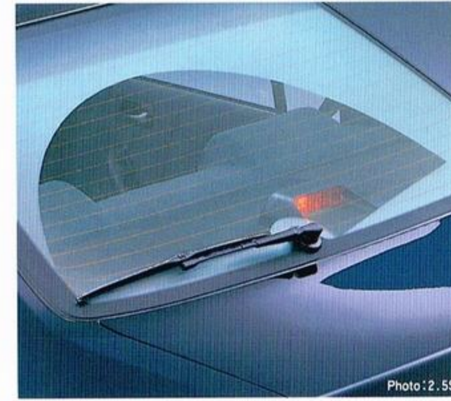
リアワイパー (2.0CS、2.5Siに標準装備 2.0TX、2.0SXにメーカーオプション) クリアな後方視界を確保するとともに、ストップランプの被視認性を向上させる。
