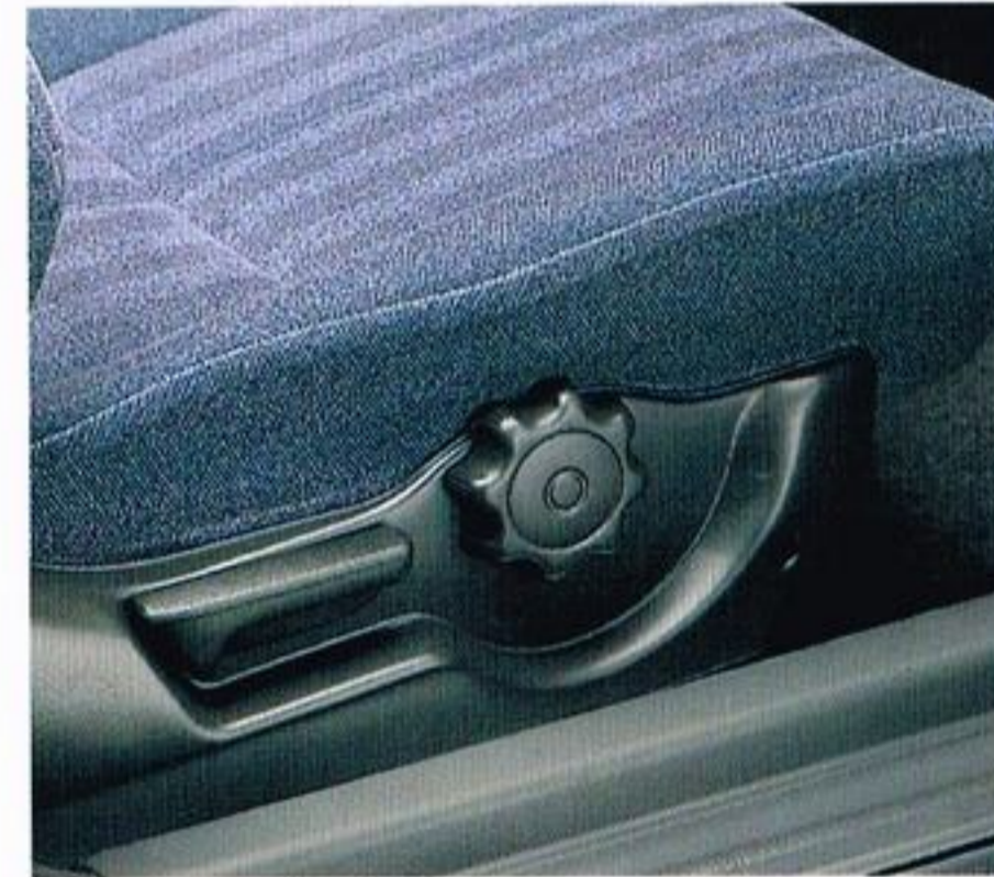
マニュアルハイトアジャスター (2.0EX、2.0TX、2.0SX) 運転席の座面の高さとともに角度が調整可能。最適なドライビングポジションが得られる。
