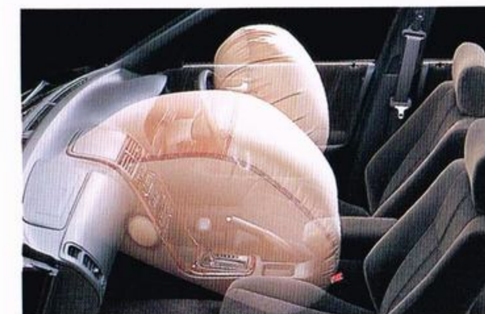
運転席用&助手席用SRSエアバッグ膨張時の写真を合成したものです。
