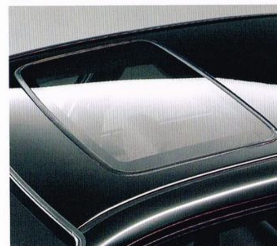
電動ガラス・サンルーフ (2.0TX、2.0SX、2.0CS、2.5Siにメーカーオプション) 直射日光をやわらげるグリーンガラスを採用。爽快なオープンエアクルージングを。
