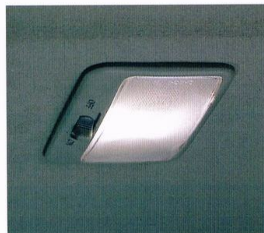
ウエルカムランプ (全車) ドア解錠と同時に室内ランプが点灯。降車時、ドアを開ける前にキーを抜くと点灯し、徐々に暗くなって消灯する。
