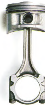
Zwevende krukpen voor minder motor trilling en -geluid
