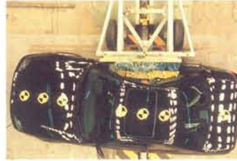
Las zonas de deformación programada delanteras y traseras han sido diseñadas para absorber la energía de los impactos.
