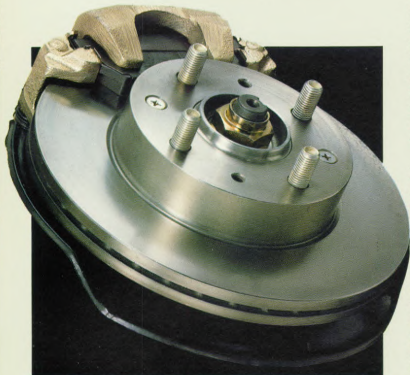
Geventileerde schijfremmen vóór maken deel uit van het zeer geavanceerde remsysteem van de Prelude.
