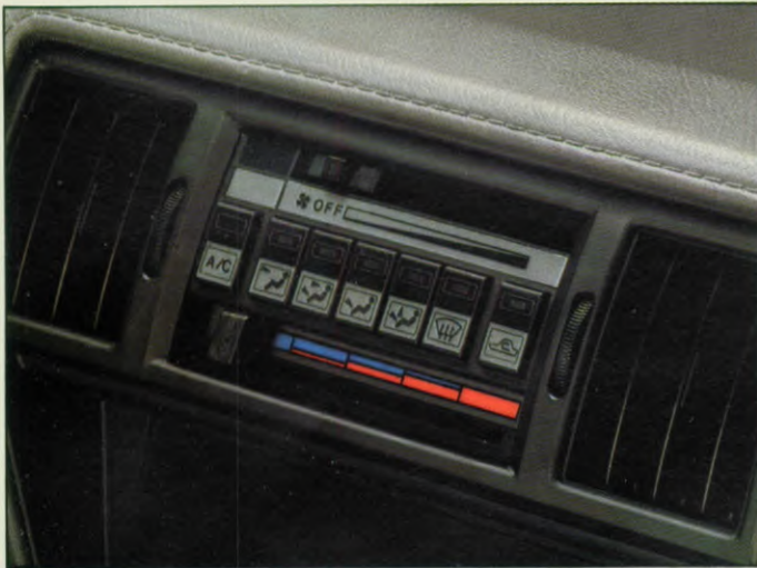
Traploos regelbare aanjager. Door middel van druktoetsen zijn verwarming en ventilatie optimaal regelbaar. Defroster op voorruit en voorste zijruiten en achterrautverwarming, het is er allemaal.
