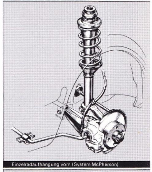
Einzelradaufhängung vorn (System McPherson)
