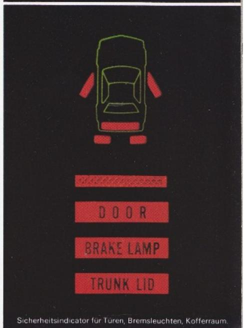
Sicherheitsindicator für Türen, Bremsleuchten, Kofferraum.
