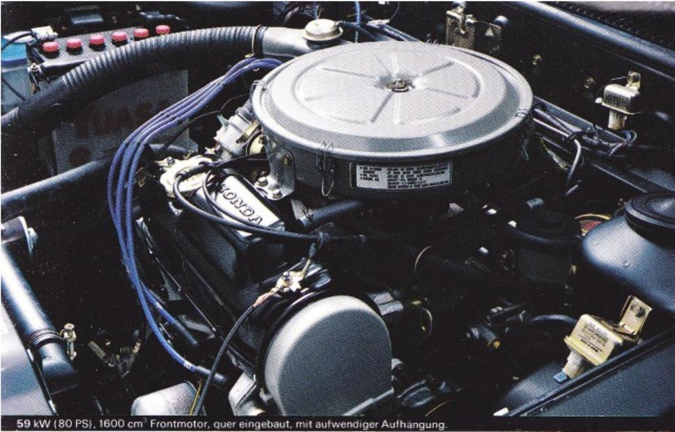
59 kW (80 PS), 1600 cm<sup>3</sup> Frontmotor, quer eingebaut, mit aufwendiger Aufhängung
