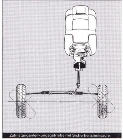
Zahnstangenlenkungsgetriebe mit Sicherheitslenksäule.
