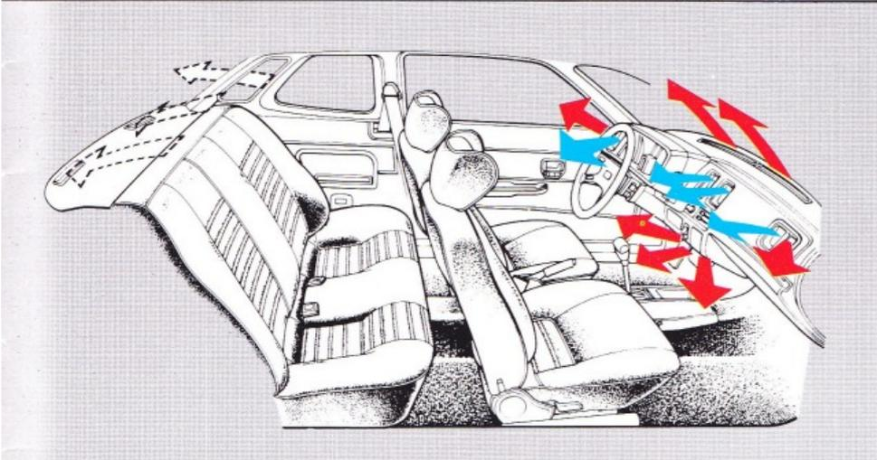
Aufwendiges Belüftungs- und Heizungssystem, automatische Zwangsentlüftung.
