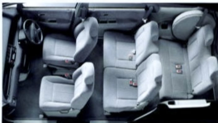
■7人乗りの基本シートレイアウト。1列目シートからコンソールボックスをなくし、2列目シートへのウォークスルーを実現。
