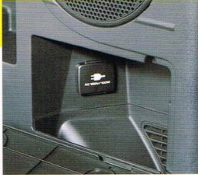
■AC100V電源 余分なコードもすっきり収納できる、 右側カーゴサイドライニングポケット内 にある電源コンセント。 AC100V電源は、定格100Wまでの電気製品の使用が可能と なっております。ただし最大消費電力が100Wを超える場合や、 消費電力が100W以下であっても、一部の機器においては 使用時の状況等により正常に作動しない場合があります。 (詳しくは取扱説明書をご確認ください)
