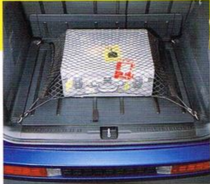
■カーゴネット 4カ所のカーゴフックに取り付けることで、 広いカーゴの中で荷物をしっかり固定できる。
