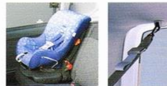
写真はISO FIX対応チャイルドシート(テザータイプ)を装着したものです。チャイルドシートはディーラーオプションです。
