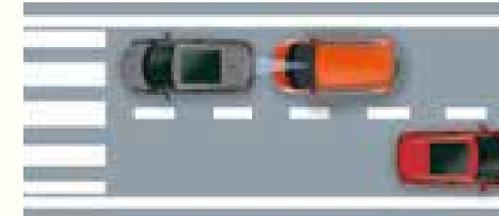
**3:** Wenn Sie nicht reagieren und eine Kollision bevorsteht, leitet der City-Notbremsassistent automatisch einen Bremsvorgang ein, um die Geschwindigkeit möglichst weit zu reduzieren. Bei guten Fahrbedingungen kann er eine Kollision sogar vollständig verhindern.
