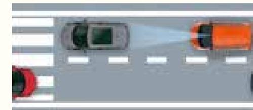
**1:** Dieses System überwacht bei Geschwindigkeiten zwischen 5 und 32 km/h im Stadtverkehr den Abstand nach vorn, um Sie vor einer drohenden Kollision zu warnen.
