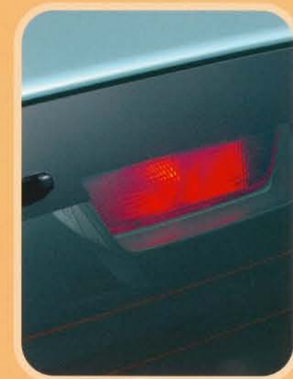
Las luces de freno traseras situadas a mayor altura permiten que los otros conductores vean antes la advertencia.
