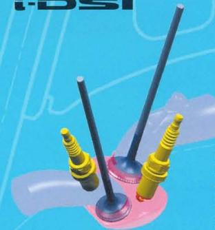
El sistema de doble bujía y la incorporación de una cámara de combustión pequeña y bien aprovechada para cada cilindro permiten sacar el máximo partido del motor i-DSI con el mínimo consumo de combustible. El bajo nivel de emisiones se reduce aún más gracias al catalizador avanzado compacto del sistema de escape.
