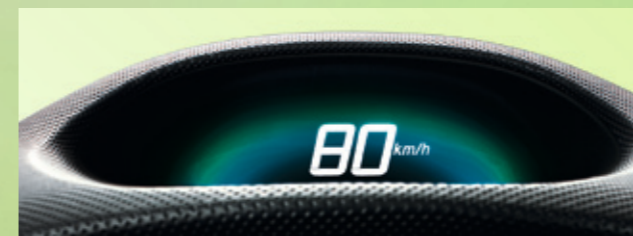
Gemäßigtes Beschleunigen und Bremsen lässt das Display blau und grün leuchten.
