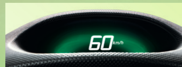
Fahren und bremsen Sie vorausschauend und ökologisch optimal, leuchtet das Display grün.
