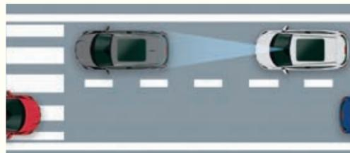
**1:** Dieses System überwacht bei niedrigen Geschwindigkeiten zwischen 5 und 32 km/h im Stadtverkehr die Fahrbahn nach vorn, um Sie vor einer drohenden Kollision zu warnen.
