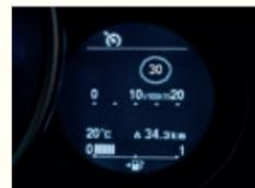
Die Verkehrszeichenerkennung erkennt bis auf 100 Meter Entfernung automatisch Verkehrszeichen und bildet sie im Multiinformationsdisplay i-MID ab. Bis zu zwei Schilder können gleichzeitig angezeigt werden.
