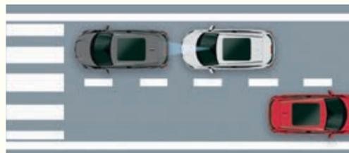
**3:** Wenn Sie nicht reagieren und eine Kollision bevorsteht, leitet der City-Notbremsassistent automatisch einen Bremsvorgang ein, um die Geschwindigkeit möglichst weit zu reduzieren. Bei guten Fahrbedingungen kann er eine Kollision sogar vollständig verhindern.
