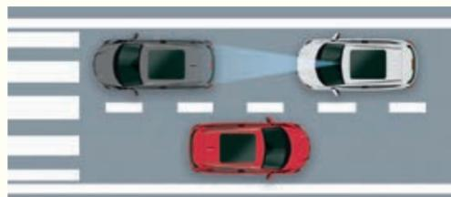
**2:** Wird der Abstand zum vorausfahrenden Fahrzeug zu gering, warnt der HR-V Sie akustisch sowie optisch über das Multiinformationsdisplay i-MID.
