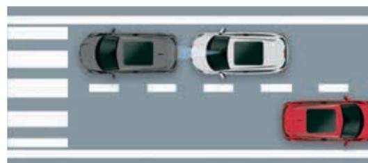
**3:** Si aun así no reaccionas y el choque es inminente, el sistema puede aplicar automáticamente una frenada de emergencia para reducir todo lo posible la velocidad. Si las condiciones de circulación son buenas, puede incluso evitar totalmente la colisión.
