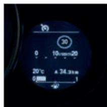
El sistema de reconocimiento de señales de tráfico identifica las señales de tráfico hasta a 100 m de distancia y muestra esta información al conductor en la pantalla multi información (MID) cuando se ha superado la señal. Puede mostrar dos señales al mismo tiempo.
