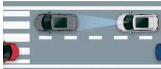
**1:** Circulando en ciudad entre 5-32 km/h, este sistema puede controlar la distancia que te separa del coche que llevas delante.
