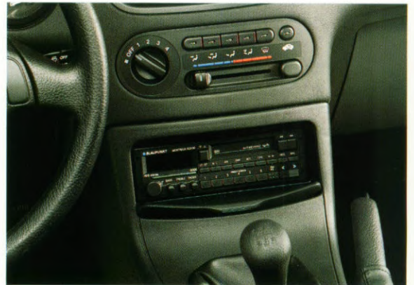
De audio-installatie kan worden afgedekt. Verwarming en ventilatie met druktoets-bediening.
