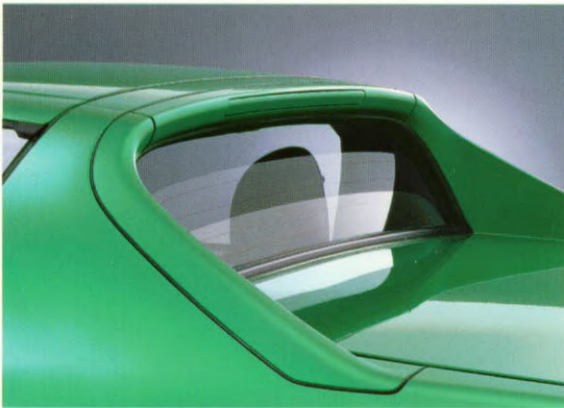
De achterraut kan elektrisch worden geopend voor een volledige doorstroming van de rijwind.
