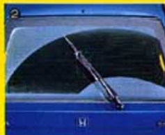
①ハロゲン・ヘッドライト②ダブルリンク・リアワイパー(ウォッシャー付)③リアスカート④175/70SR13スチールラジアルタイヤ(5速マニュアル)・165/70SR13スチールラジアルタイヤ(3速フルオート)
