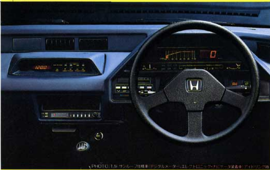
PHOTO 1.5i サルーフ仕様車(デジタルメーター、エレクトロニック・ナビゲータ装着車)アイドリング時
