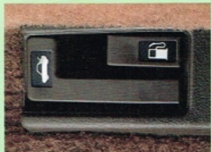
●トランクオープナー&フューエルリッド オープナー(どちらもCR-G, CR-Z)
