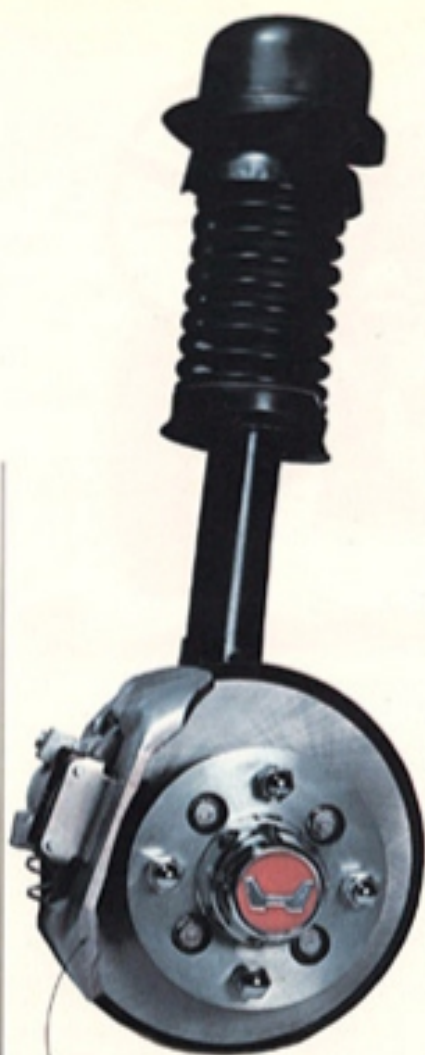
前輪ディスクブレーキ。ディスクをくわえるキャ リパーも前部に配置。制動効果は万点。
