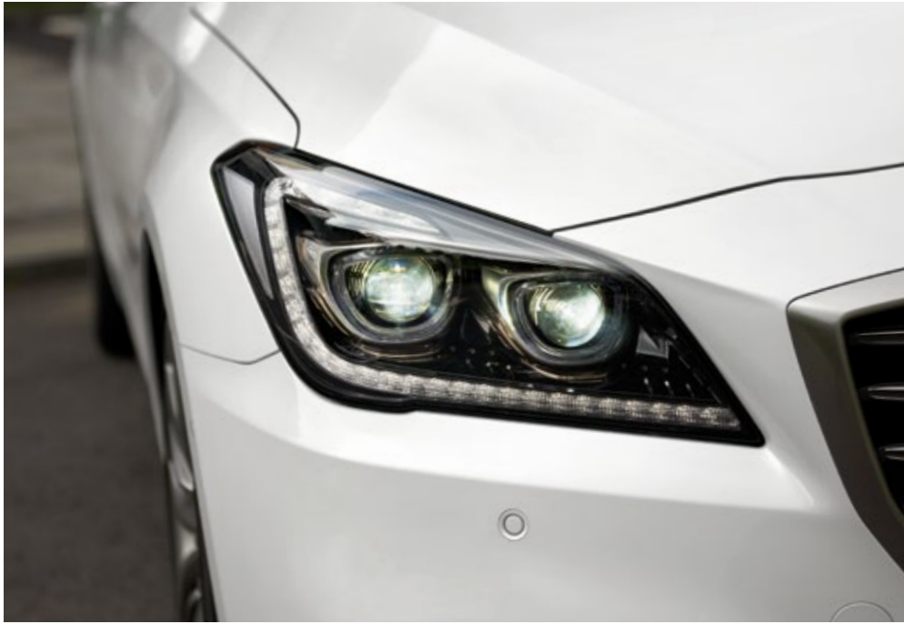
어댑티브 Full LED 헤드램프 _ 입체적인 형상의 헤드램프가 GENESIS G80 고유의 고급감을 드러냅니다. 고속 주행이나 선회 시 상황별로 빔 패턴을 변환하여 보다 넓은 시야를 제공함으로써 안전한 주행을 돕습니다.
