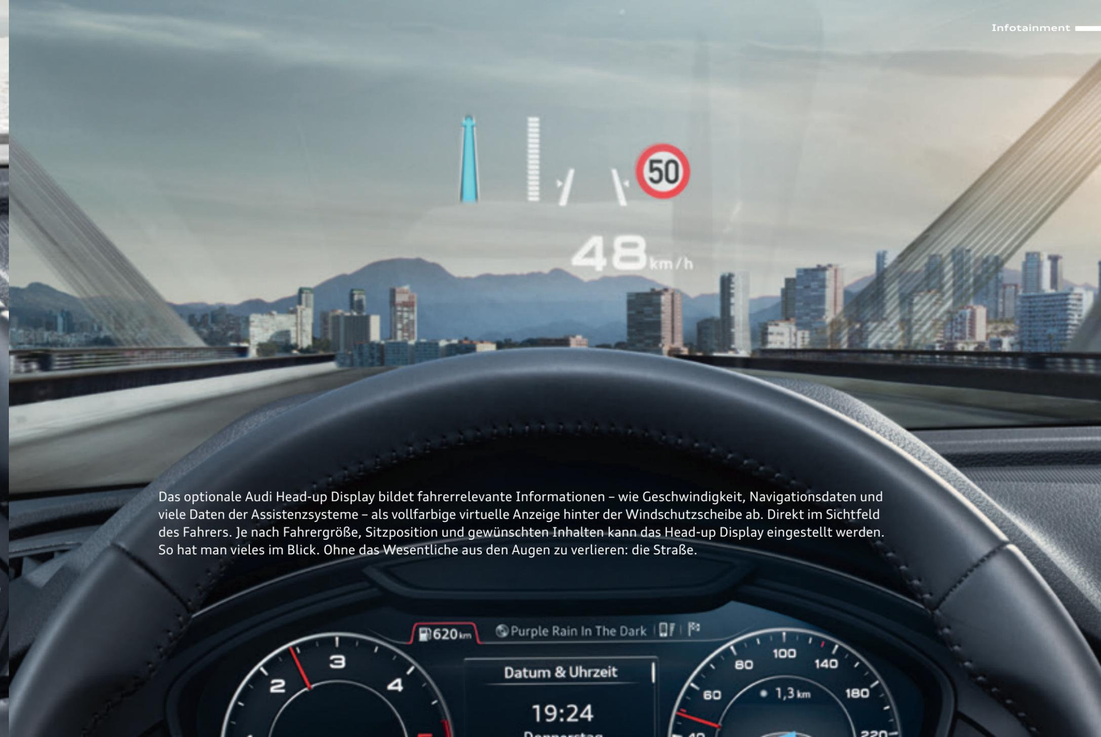
Das optionale Audi Head-up Display bildet fahrerrelevante Informationen – wie Geschwindigkeit, Navigationsdaten und viele Daten der Assistenzsysteme – als vollfarbige virtuelle Anzeige hinter der Windschutzscheibe ab. Direkt im Sichtfeld des Fahrers. Je nach Fahrergröße, Sitzposition und gewünschten Inhalten kann das Head-up Display eingestellt werden. So hat man vieles im Blick. Ohne das Wesentliche aus den Augen zu verlieren: die Straße.
