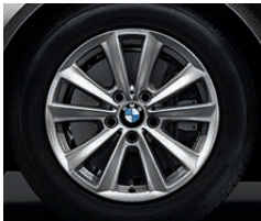
铝合金轮圈，V式轮辐 236型，17英寸，防爆轮胎，8 J x 17英寸，配 225/55 R 17 轮胎。
