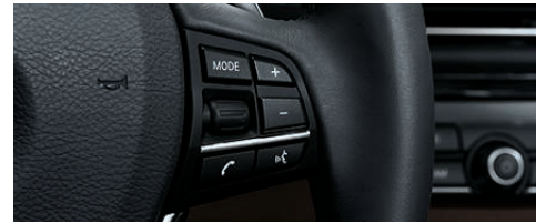
多功能方向盘可用于控制电话、语音和音响功能，具体取决于车辆上安装的装备。
