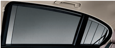
遮阳帘 ，后风挡玻璃采用电动遮阳帘，侧窗采用手动遮阳帘。
