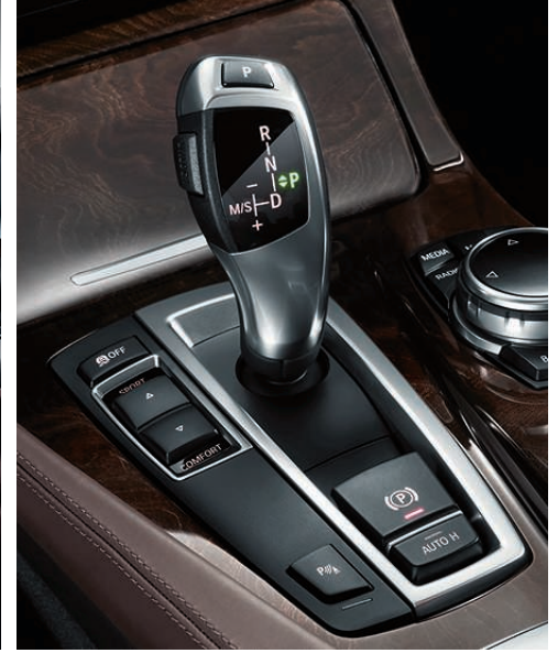
8速手自一体变速箱，该变速箱凭借间隔紧凑的齿轮比显著提升了换挡和驾驶舒适性，并将每次换挡时发动机转速的变化量大大减少。这还显著提高了运动性并降低了油耗。此外，还可通过换挡杆手动换挡。
