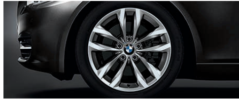
铝合金双色轮圈，双辐式样 609型，18英寸，防爆轮胎，前轮 8 J x 18英寸，配 245/45 R 18 轮胎，后轮 9 J x 18英寸，配 275/40 R 18 轮胎。
