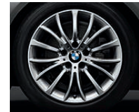
铝合金轮圈, 多辐式 454 型, 18 英寸, 防爆轮胎, 8 J x 18 英寸, 配 245/45 R 轮胎。
