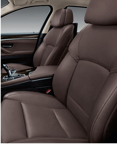
前排舒适型座椅 ，包括主动式头枕和电动调节功能。靠背上部、靠背宽度、大腿支撑和头枕高度均可调节。此外，还包括前排座椅电动腰撑和记忆功能。
