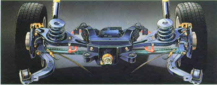
Die Zentrallenker-Hinterachse des BMW 3er Coupé wird von zwei Querlenkern und einem Längslenker geführt.
