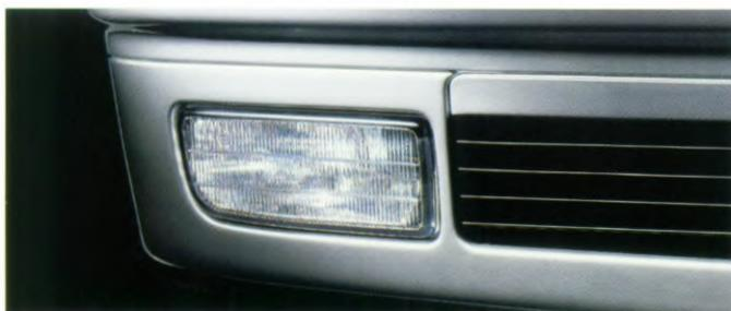
Nebelscheinwerfer in Freiformtechnik sorgen für zusätzliche Sicherheit bei schlechten Sichtbedingungen (serienmäßig ab 323i).
