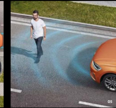
**05 Front Assist con riconoscimento pedoni.** Rileva la presenza di veicoli che precedono e di eventuali pedoni. In caso di necessità, avvisa il conducente o interviene sul sistema frenante per evitare collisioni o per ridurre l'entità.
