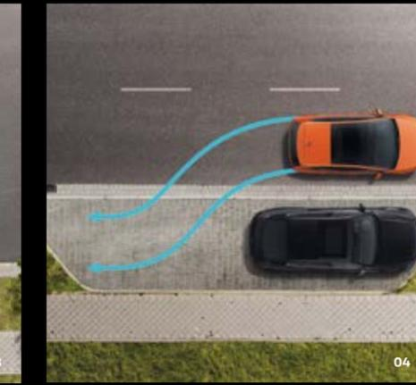
**04 Park Assist.** Parcheggia in modo semiautonoma la vettura, agendo sullo sterzo e lasciando al guidatore solo il compito di frenare e accelerare. In fase di manovra, grazie alla funzione di frenata di emergenza, il sistema agisce sull'impianto frenante in caso di necessità.
