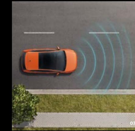
**03 Adaptive Cruise Control.** Regola automaticamente la velocità mantenendo la distanza prestabilita dai veicoli che precedono. Abbinato al cambio DSG, presenta la funzione Stop-and-Go, utile in condizioni di traffico intenso.
