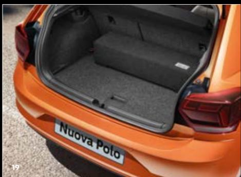
**19** **Sistema audio Plug & Play.** L'amplificatore a 5 canali con processore sonoro digitale integrato, dalla potenza complessiva di 300 watt sinus / 480 watt musicali ed un subwoofer di grande potenza, garantisce la massima qualità sonora. Il sistema utilizza gli altoparlanti predisposti sulla vettura e consente l'installazione "Plug & Play" nel bagagliaio.
