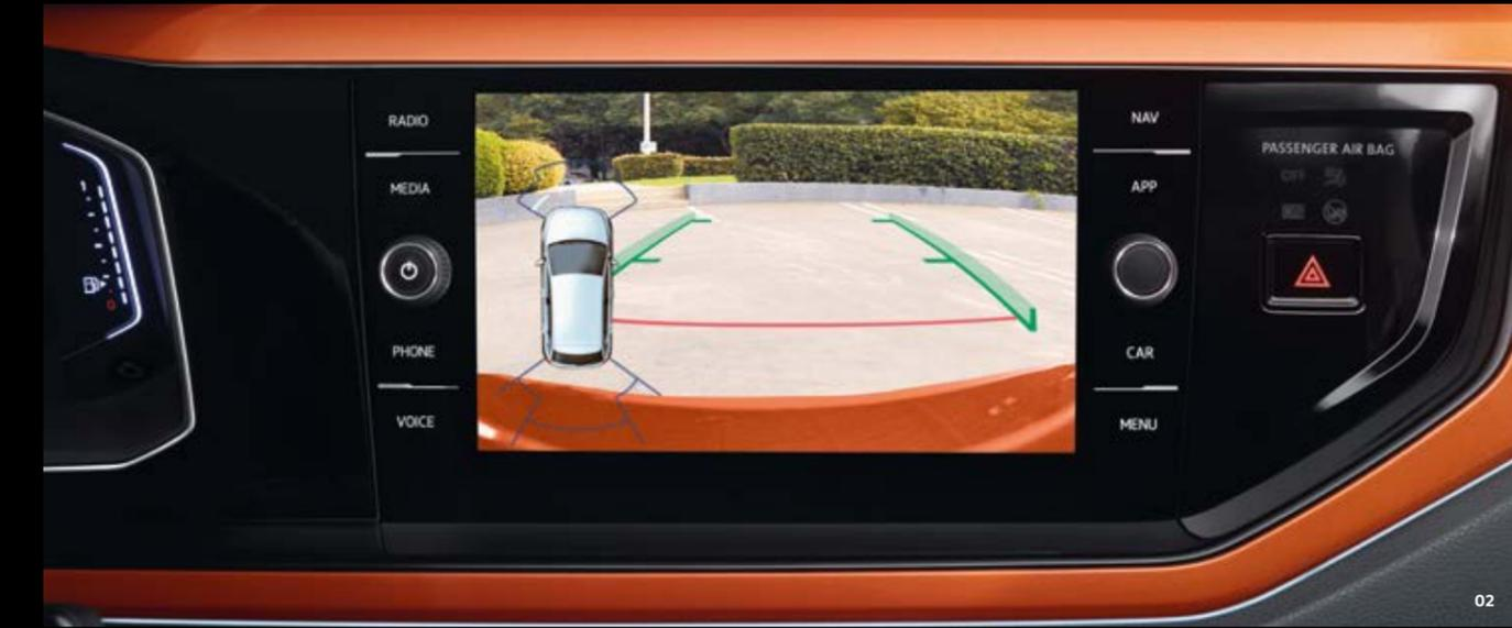
**02 Rear View Camera.** La telecamera per la retromarcia permette di visualizzare sullo schermo del sistema di Infotainment ciò che accade dietro all'auto, aiutando a valutare ostacoli e distanze in fase di manovra con maggiore precisione.
