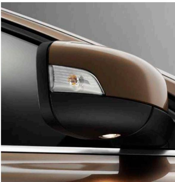
Retrovisores exteriores retractables eléctricamente con iluminación inferior
