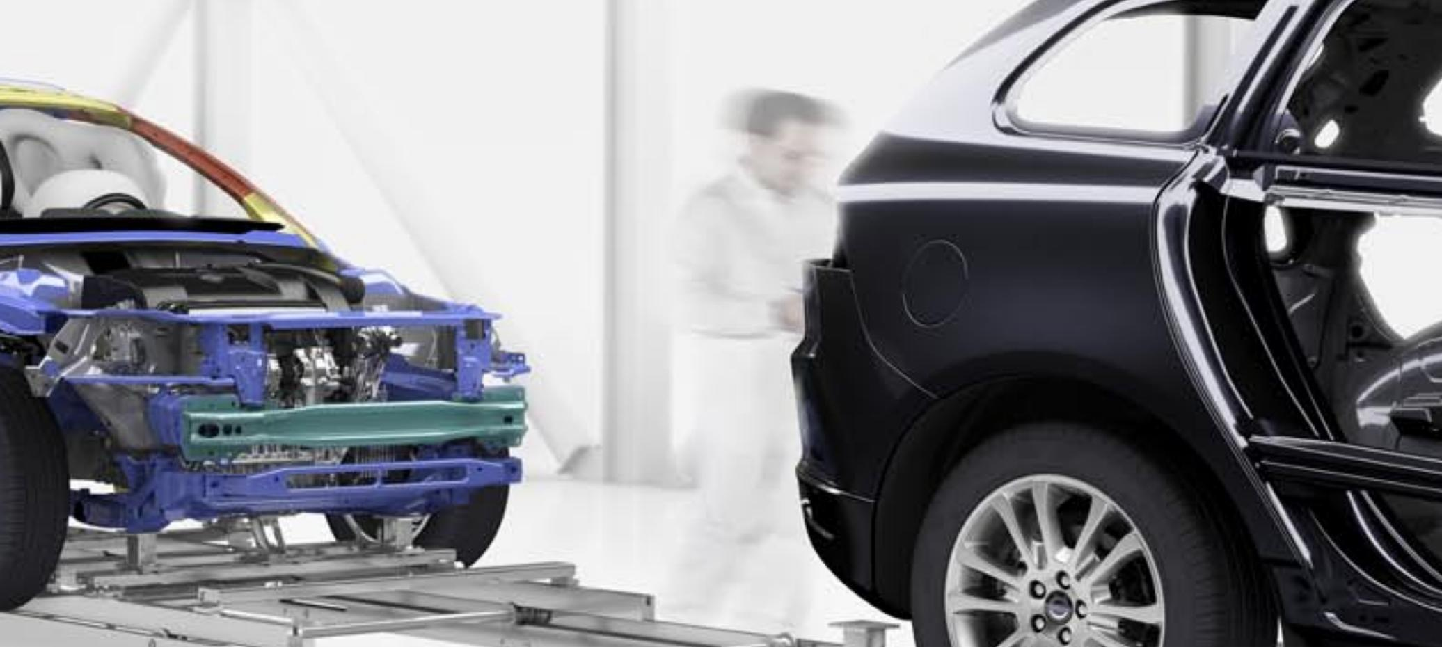
**En cas de tonneau,** le système anti-tonneau ROPS active les prétensionneurs des ceintures de sécurité de chacun des sièges pour offrir une meilleure retenue aux occupants. Le rideau gonflable IC se déploie pour protéger la tête des occupants et les maintenir à l'intérieur de l'habitacle. La cage de sécurité est également renforcée pour aider à conserver le compartiment passagers intact.
