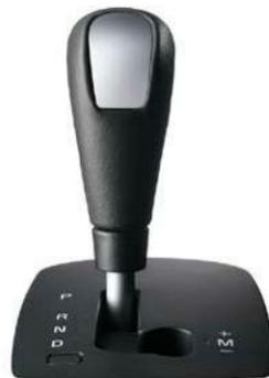
Manípulo da caixa em couro com aplicação em alumínio, Geartronic
