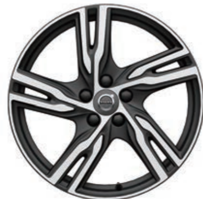
“Ixion IV” 7.5J×18インチ ダイヤモンドカット/マットブラック T5 R-Design 標準装備
