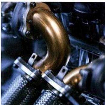
O motor de 272 cv no S80 T6 possui dois pequenos turbocompressores.
