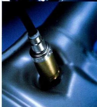
*Con il convertitore catalitico a tre vie abbinato alla sonda Lambda preriscaldata è stato possibile abbattere del 95% le sostanze nocive - monossido di carbonio, biossido di azoto e idrocarburi incombusti - presenti nei gas di scarico.*
