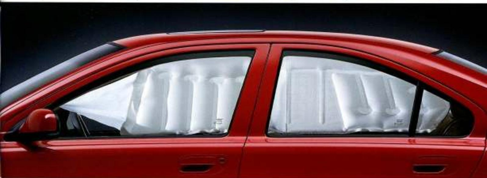
O sistema de protecção contra impactos laterais (SIPS) exclusivo da Volvo utiliza uma grande parte da carroçaria do veículo como meio de absorção da força de impacto. A introdução de IC e airbags laterais garante protecção máxima para a cabeça e o tórax.
