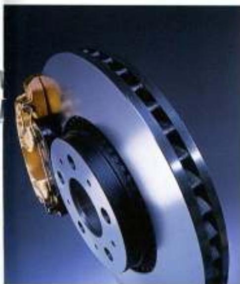
O sistema de travagem ABS, de dimensões generosas, integra discos em todos os travões, discos esses ventilados à frente. O EBD (Electronic Brake Distribution) distribui o poder de travagem entre as rodas dianteiras e traseiras para máxima eficácia a qualquer momento, mesmo quando o automóvel circula fortemente carregado.
