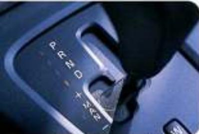
A transmissão automática adaptável Geartronic de cinco velocidades pode também ser comandada manualmente para uma condução mais activa. Avance para a velocidade seguinte empurrando a alavanca da caixa ou reduza puxando-a na sua direcção (disponível como opção com os motores turbo a gasolina de 200 e 250 cv).
