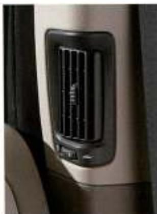
Aberturas de ventilação e aquecimento separadas para os passageiros do banco de trás proporcionam maior conforto e ajudam a eliminar o gelo e embaciamento dos vidros laterais (opcional, incluído com ECC).
