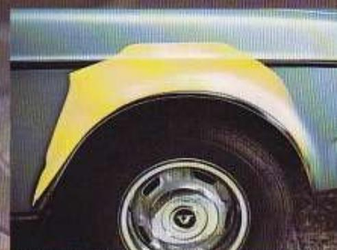
Les passages de roues avant, à l'intérieur, sont munis de pare-boue distincts en polypropylène qui protègent la carrosserie des jets de pierre et des saletés. Le risque de corrosion s'en trouve amoindri.
