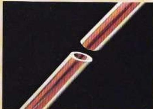
Les canalisations de freins sont en alliage de cuivre, particulièrement robuste et qui résiste bien à la corrosion.
