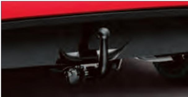
Anhängezugvorrichtung mit abnehmbarer Kupplungskugel, horizontale Verriegelung
