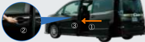
①パワースライドドア閉動作 ②スマートロック操作で施錠を予約 ③パワースライドドア閉後、施錠完了
