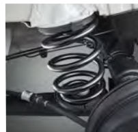
トレーリングリンク式リアコイルサスペンション
