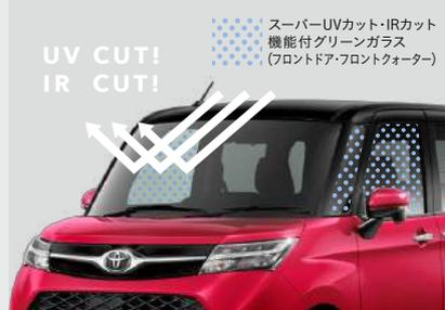
ウインドシールドグリーンガラス、フロントドアとフロントクォーターのガラスは日焼けの原因となる紫外線(UV)を約99%カット\*1。紫外線の強い季節や時間帯でも、気軽にドライブを楽しめます。また、日射しによるジリジリした暑さのもとである赤外線(IR)カット機能付です。
