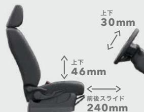
運転する方の体格に合わせて、シートの高さやステアリングの位置を最適なポジションに調整できます。
