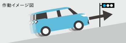
坂道での発進時、ブレーキからアクセルに踏み替える際に、ブレーキ油圧を保持することによって、車両のずり落ちを緩和し、スムーズな発進を実現します。
