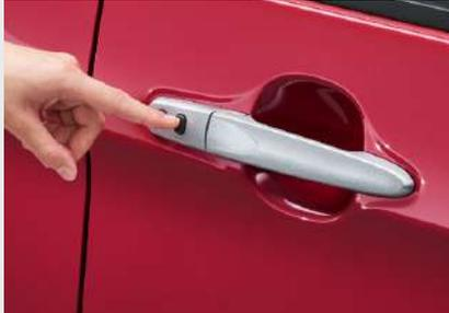
電子カードキーを携帯していれば、バッグから取り出さずにドアハンドルのリクエストスイッチを押すだけでドアを施錠・解錠できます。エンジン始動もブレーキを踏みながらスイッチを押すだけで簡単に行えます。さらにIDコードが登録された正規キー以外では、エンジンが始動しない盗難防止に役立つイモビライザー機能付です。
