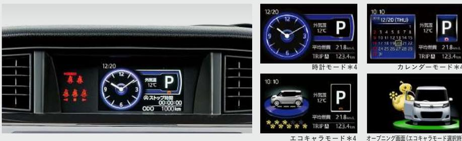
4.2インチの高精細な液晶に、ウォーニングやメンテナンスといったクルマからのさまざまな運転情報を表示。さらにエコキャラモードなどの楽しい画面も用意しています。運転席から見やすいインパネ中央部に配置しているので、走行中の視線移動が少なく快適です。
