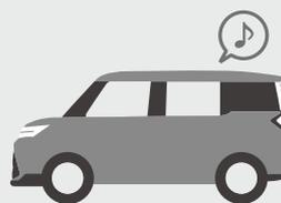
高速道路を走行中でも快適に会話を楽しめる静粛性を実現しています。それはクルマの随所に吸音材を配置し、音の経路の遮断や侵入を抑制するなど、さまざまな工夫を積み重ねることで、エンジンの透過音やロードノイズ、こもり音などを低減しているからです。
