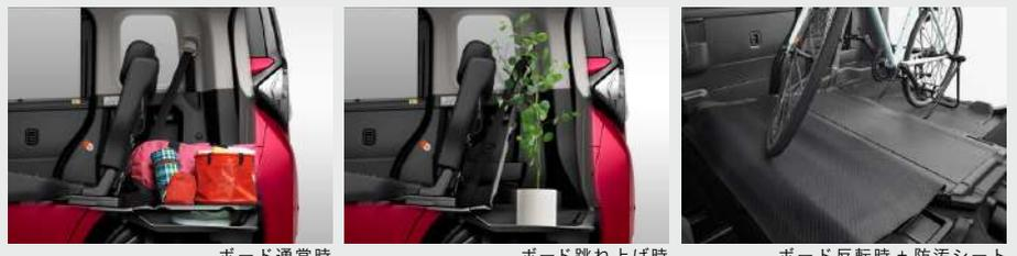
デッキボードを跳ね上げ、フックをリヤヘッドレストに固定すれば、高さのある荷物の積載が可能。リヤシートをダイブインさせてボード裏面にある防汚シートを展開すると、室内を汚すことなく積み込めて便利です。
