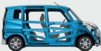
前・後ろ・横からの衝突実験を実施。衝撃を効率よく吸収・分散するボディと強固なキャビンで、十分な客室空間を確保します。
