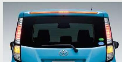
急ブレーキをかけたるとハザードランプが自動的に点滅。被視認性を高めた大きなランプで後続車に注意を促し、追突される可能性の低減に寄与します。
