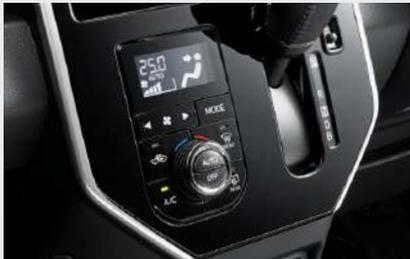
操作しやすいプッシュ式パネルに、見やすい液晶表示を採用。駐車時などイグニッションOFF状態で外気モードになるので、車内のこもり臭を防ぎます。
