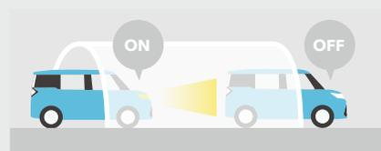
車外の明るさに応じて自動的にヘッドランプなどを点灯・消灯。日暮れ時やトンネルなどで役立ちます。
