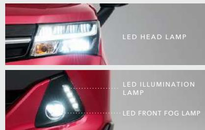
先行車・対向車への眩惑防止に配慮したオートレベリング機能付のLEDヘッドランプと、霧の発生など悪天候時の視界確保をサポートするLEDフロントフォグランプを採用しました。
