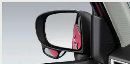
運転席から見づらい助手席側の前輪・後輪付近を映すサイドアンダーミラーが視野の拡大に貢献。路肩への幅寄せやバック駐車をサポートします。
