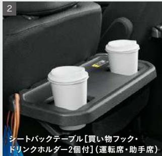
シートバックテーブル[買い物フック・ドリンクホルダー2個付](運転席・助手席)
