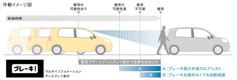
■警報は対車両の場合は自車速度約15km/h～140km/h\*、対歩行者(昼間)の場合は自車速度約15km/h～65km/h、自動(被害軽減)ブレーキは対車両の場合は自車速度約10km/h～80km/h、対歩行者(昼間)の場合は自車速度約10km/h～65km/hで作動します。また、道路状況、車両状態、天候状態およびドライバーの操作状態等によっては、作動しない場合があります。詳しくは取扱書をご覧ください。 ■プリクラッシュセーフティはあくまで運転補助機能です。本機能を過信せず、必ずドライバーが責任を持って運転してください。 ■数値は社内測定値。
