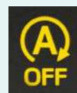
エコアイドル インジケーター (アイドリングストップ オフ状態表示)
