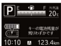
キーフリー電池残量警告灯 (TFTマルチインフォメーションディスプレイ)
