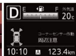
コーナーセンサー作動表示 (TFTマルチインフォメーションディスプレイ*1*2)
