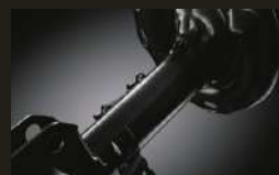
専用チューニングサスペンション (フロント約20mmダウン・リヤ約25mmダウン)
